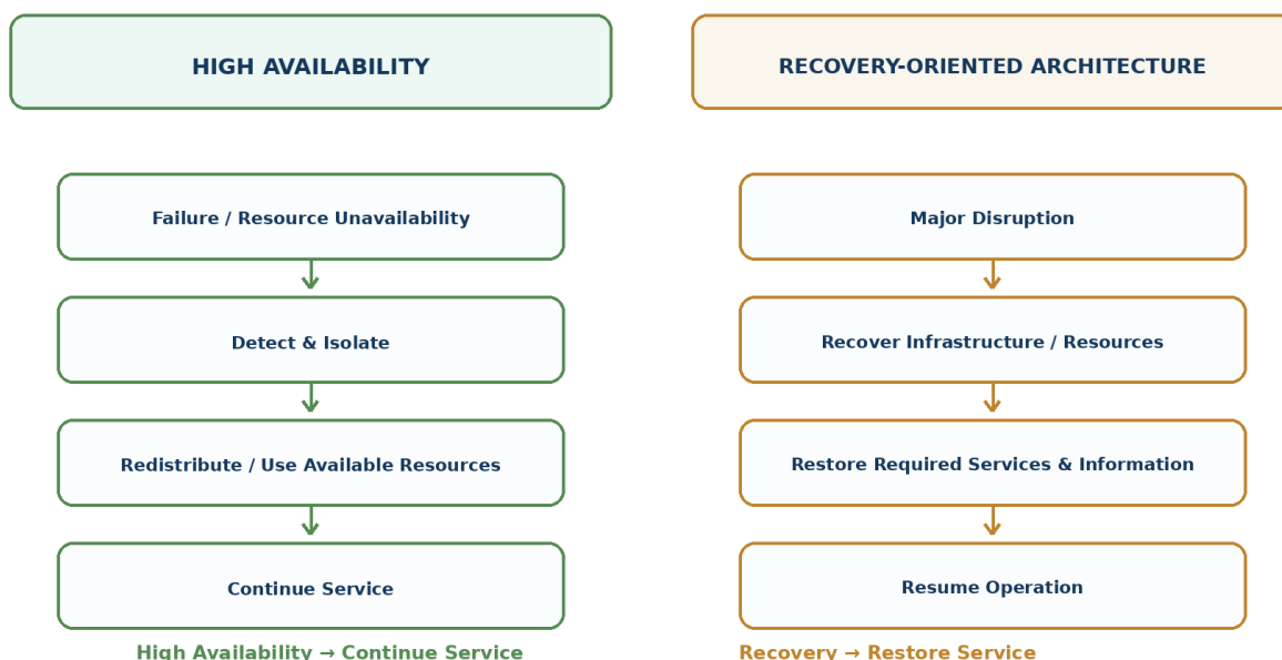
圖 9-5 — 高可用性與復原導向架構
